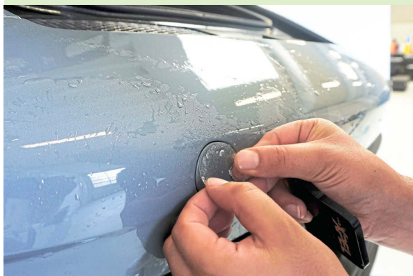
▲ Selbst kleinste Bauteile wie die Abschleppösen-Abdeckungen werden foliert. Die Ultimate Fusion von XPEL haftet auch an Kanten, keine Gefahr von Schmutzrändern
