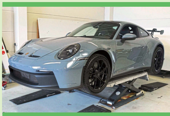
▲ Optisch perfekt, da unsichtbar: die XPEL-Schutzfolie Ultimate Fusion. Sie besteht aus einem elastischen Kunststoff, dessen Oberfläche keramikbeschichtet ist
