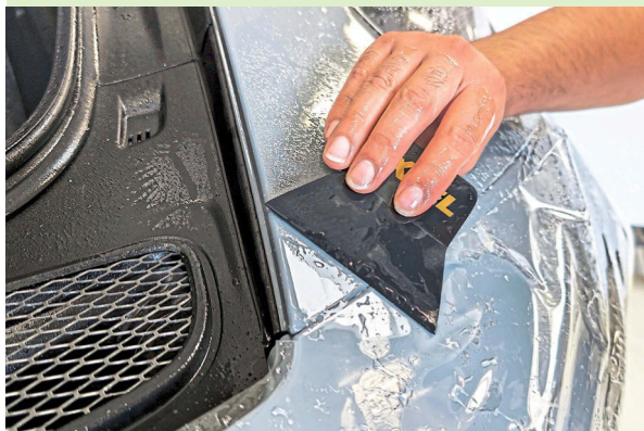
▲ Gerakelt wird die Folie von der Mitte eines Bauteils zu deren Rand hin. Eventuelle Luft einschlüsse werden so zuverlässig entfernt. Am Ende liegt die Folie völlig glatt an
