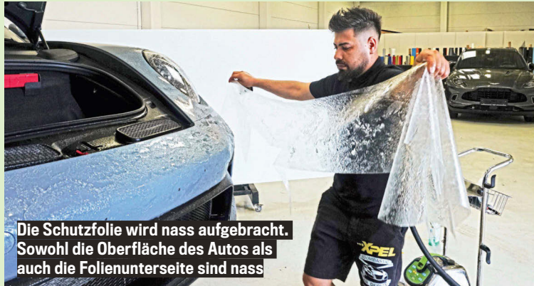
Hier ist die gelartige Konsistenz gut zu erkennen. Nach Aufbringen der Folie verdunstet das Gel langsam, sorgt so für eine perfekte Haftung auch bei kleinen Bauteilen
